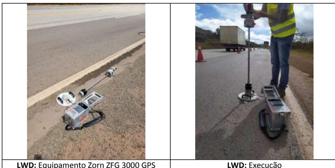
Figura 3.14 - Execução do Levantamento LWD, na pista experimental.
