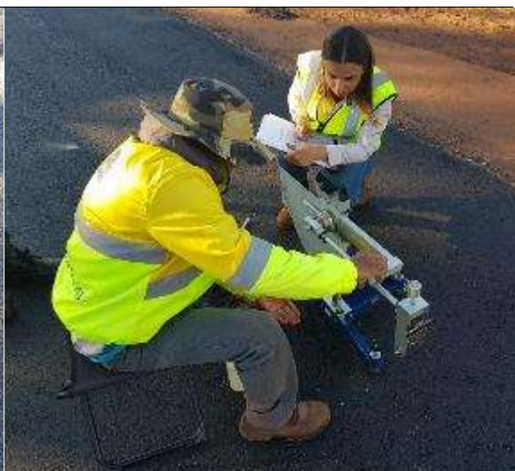
**Revestimento:** Ensaio do Pêndulo Britânico
