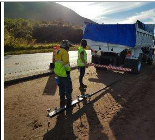
**Base:** Ensaio Viga Benkelman
