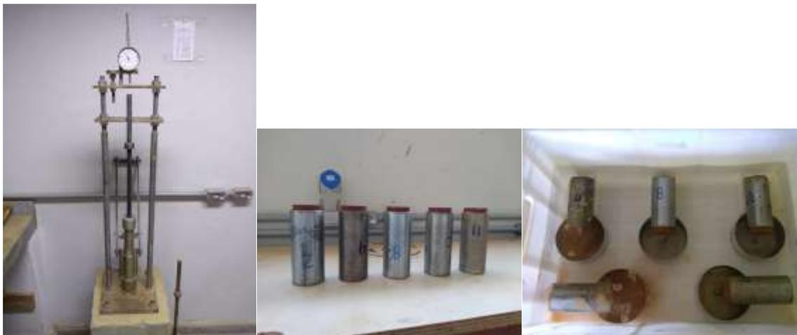
Figura 2.5 - Ensaio de compactação Mini-MCV.
