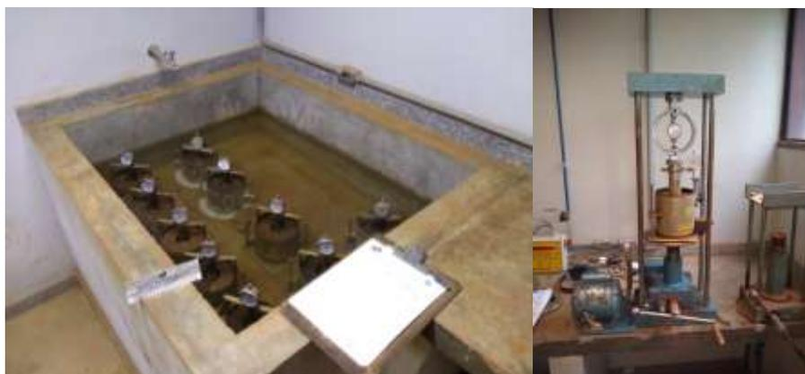
Figura 2.7 - Ensaio de Expansão e CBR
