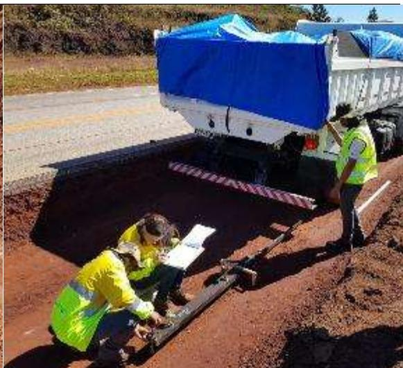
**Regularização do Subleito:** Ensaio de Viga Benkelman
