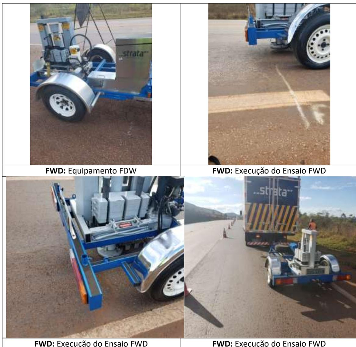
Figuras 3.17 – Processo de medição com o FWD
